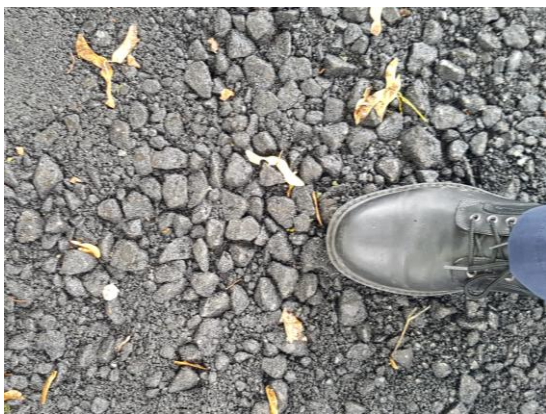
Entmischte "definitiv" eingebaute Tragschicht
